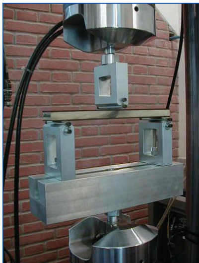
[Fig. 4] - Prova di flessione a tre punti su pannello sandwich in laminato carbonio/epossidica con anima in schiuma polimerica / Three-point bending test on a carbon/epoxy skin, polymeric foam core sandwich panel
